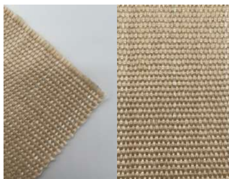
TEJ VIDRIO MED 940 GR/M2 CAMELIZADO Espesor nominal 1,2mm Temp. 550°C Certificación naval
