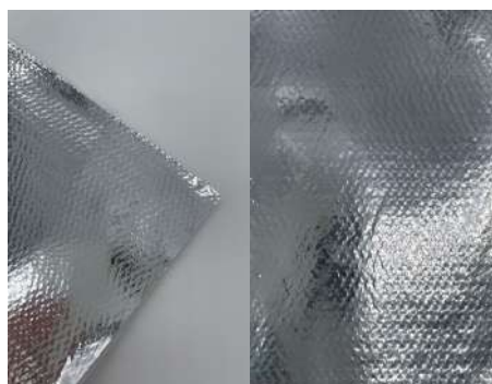
TEJ VIDRIO 520GR/M2 PESFOIL ALU 1 CARA Espesor nominal 0,4mm Temp. 550°C y 180°C
